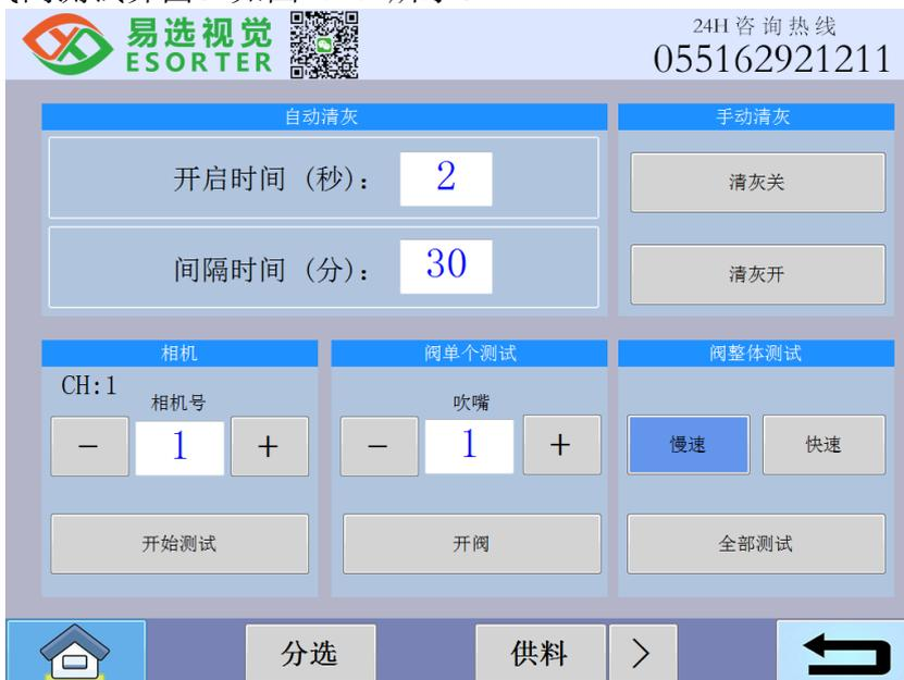
图 3-5 气阀测试界面
